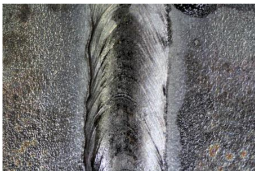
Рис. 2. Внешний вид сварного шва с нанообразованиями
