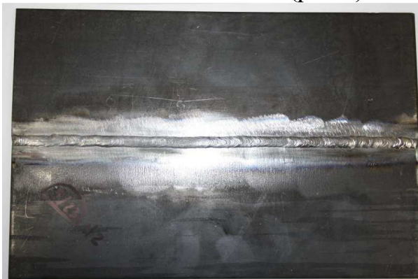
Рис. 1. Исходное состояние сварного шва после зачистки
