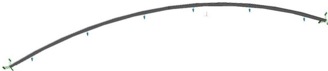
Модель двух горячекатаных балок с закреплениями и распределенной силой
